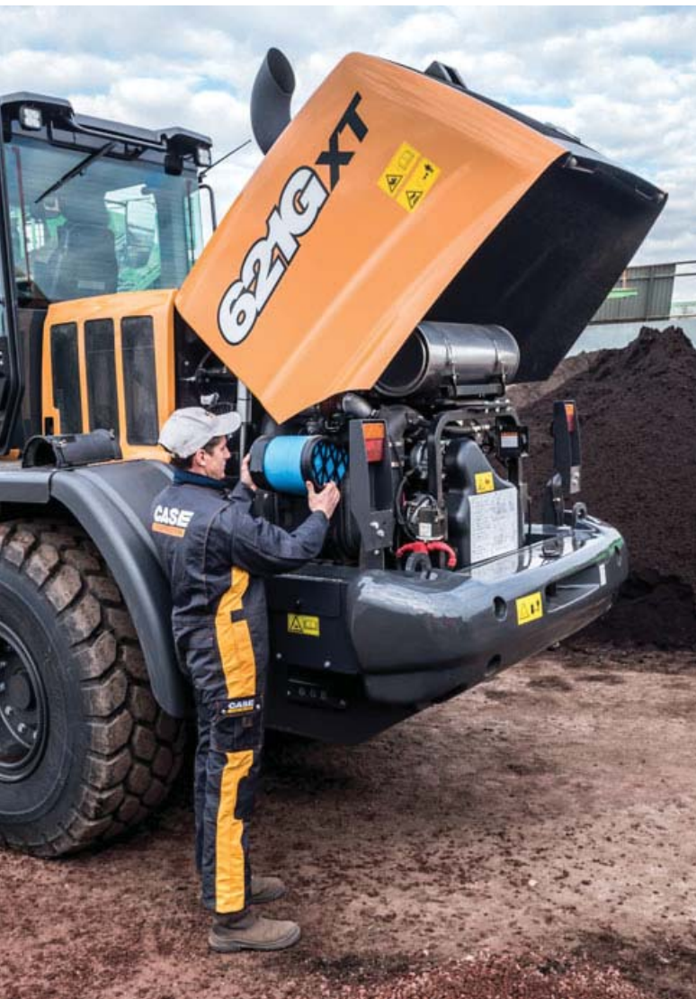
Układ komponentów pod maską został zoptymalizowany i ułatwia konserwację.
