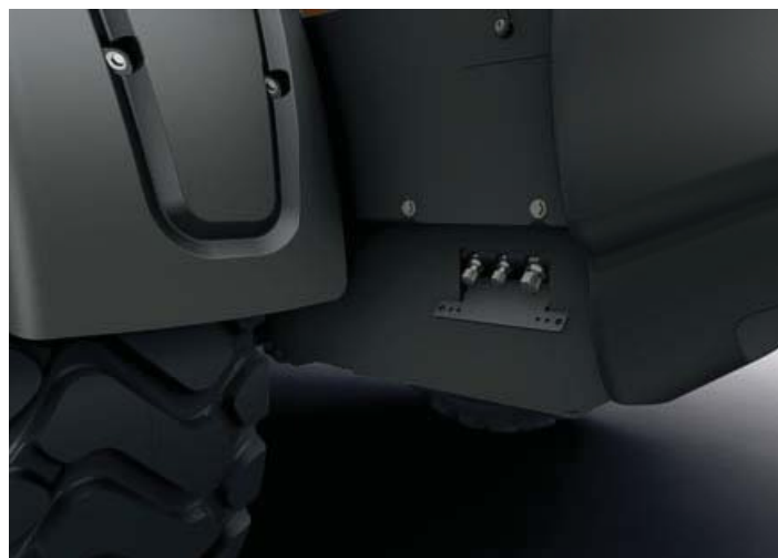
Spusty pogrupowane w celu zapewnienia czystej i szybkiej wymiany płynów eksploatacyjnych.
